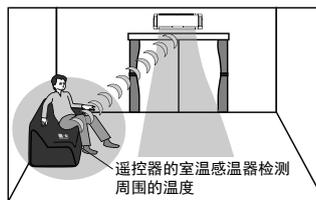
当遥控器感温器检测到温度过高或温度过低时，会自动控制设定温度，维持既舒适又节能的运转状态。
