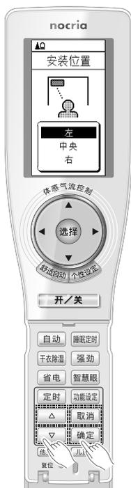
(例) 将室内机安装在左侧时
