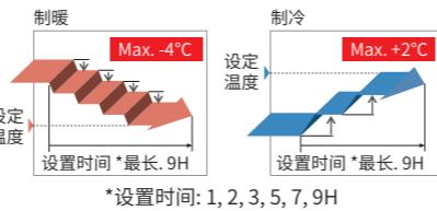
温度设置后会渐渐的自动匹配你的睡觉时间, 达到既节能又舒适的定时器功能。
