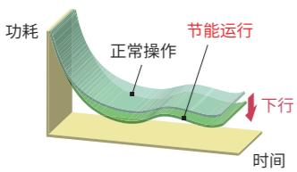
省电运行操作, 使用遥控器上的节能按钮, 通过房间的温度调节, 实现降低功耗和节能。
