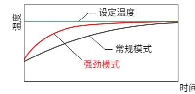
可持续20分钟最大气流操作和压缩机运转, 使房间的温度(制冷或制热)迅速达到舒适。
