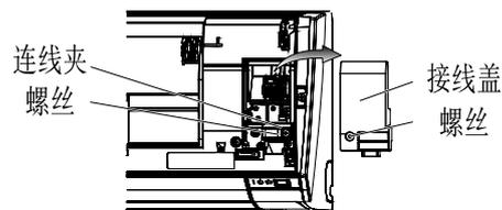
● L、N端及接地线请使用1.0mm<sup>2</sup>或以上连接电缆, 如果使用低于1.0mm<sup>2</sup>的连接电缆, 有可能会引起电路着火。
